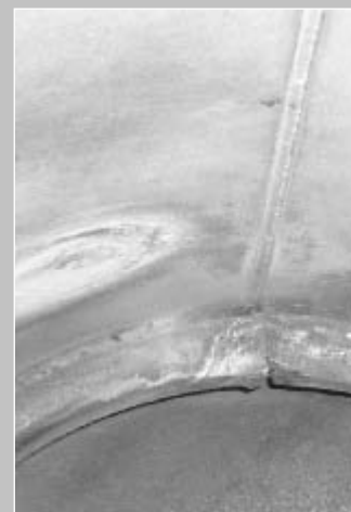
Surriscaldamento, cricca da corrosione
